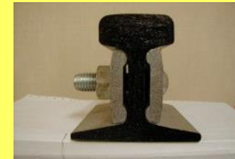
ペーシ (レールの継目板)
