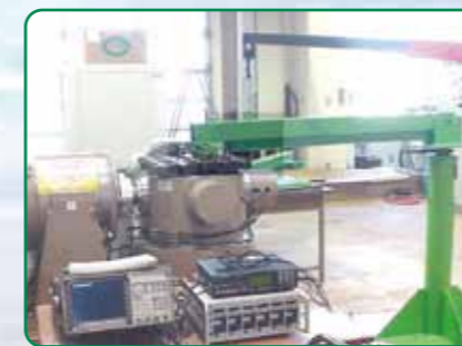
図2 縮小モデルを用いた振動実験
