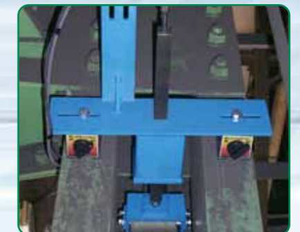
レールレベル測定装置外観
