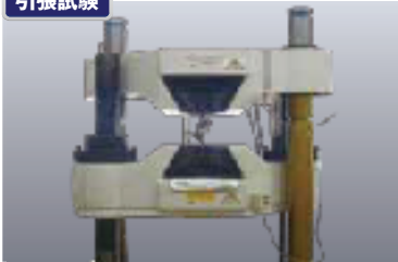
(図1) レールキーパー引張試験 〔場所〕 香川県産業技術センター
